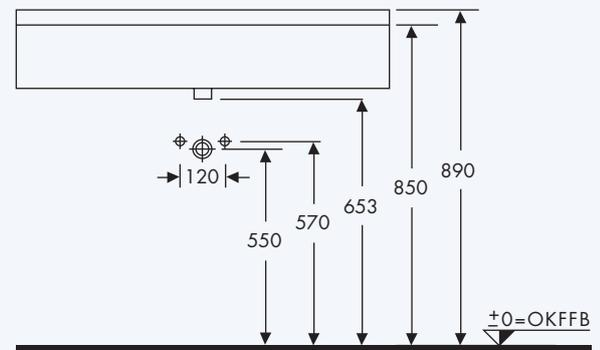
Beckenplatzierung innerhalb der Min./Max.-Maße frei wählbar
